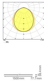
**Technische Daten Ledvance LED Tragschiene Trusys Flex Opal Stahl Weiß 35W 5600lm 90D - 840 Kaltweiß | Dali Dimmbar**
