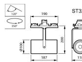
**Technische Daten Philips LED Schienenstrahler Spot Greenspace Maxos Fusion GEN2 ST321S Weiß 19W 2700lm 38D - 830**
