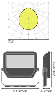
**Caractéristiques Ledvance Projecteur LED GEN 3 Blanc 50W 6000lm 100D - 840 | IP65 - Symétrique - Remplacement 100W**
